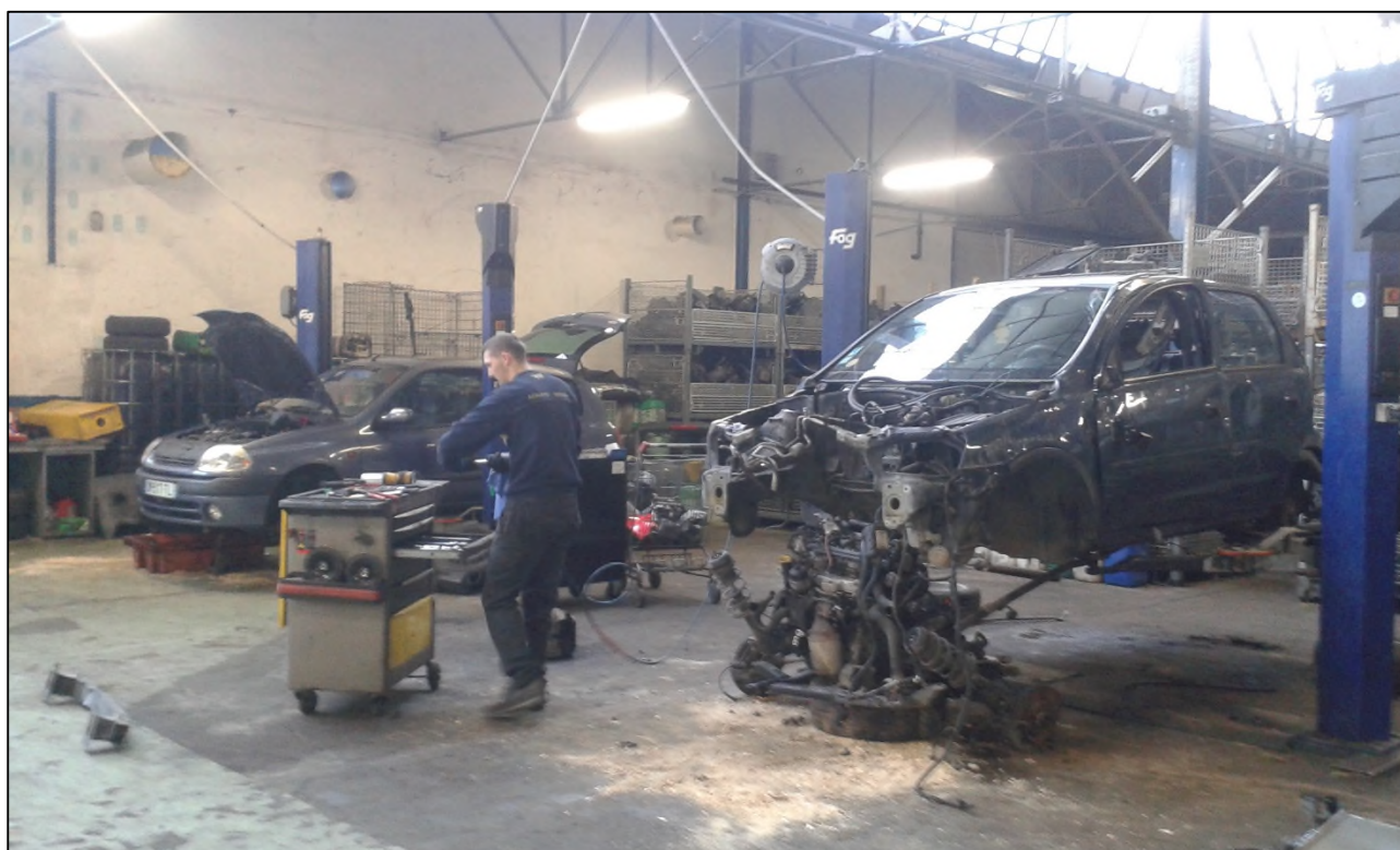
VHU en cours de dépollution et démontage
